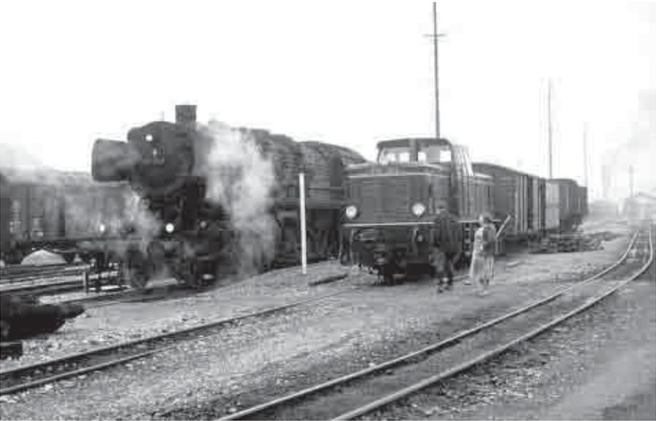
*Normalspur- und Schmalspurlok nebeneinander am Südbahnhof – links eine Dampflokomotive der BR 50, rechts eine Diesellokomotive mit einem bunt zusammengewürfelten Zug.
